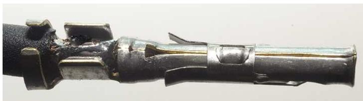
J'ai opté pour un point de soudure ou alors la possibilité d'un sertissage avec une pince à cosse adapté aux petites griffes.
