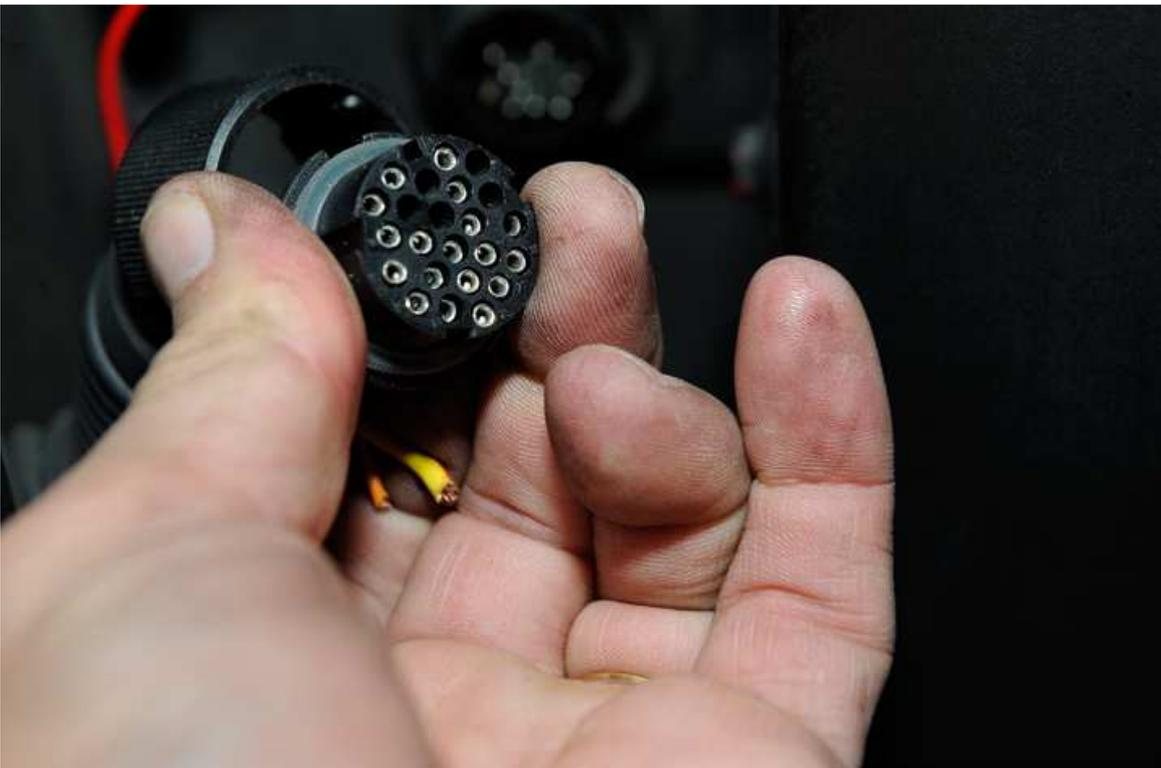
Pousser le Flexible complet dans l'intérieur de la portière et extraire le faisceau, vous pouvez à ce stade, utiliser la pince coupante pour couper les câbles à 2-3 cm du connecteur.
